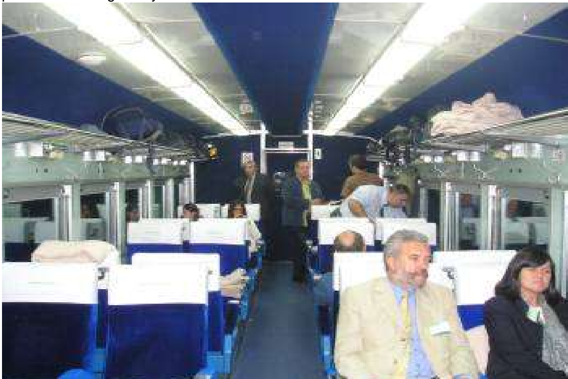
2- Interior del servicio Primera Clase, podemos observar el espacio en la parte superior de las butacas para colocar equipaje de mano, colocar trípodes, o sillas de ruedas plegables. Vemos también que los apoyabrazos de las butacas son rebatibles y que el espacio para circular por los pasillos en silla de ruedas no es apto.
